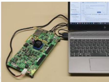
FPGAに論理回路のデータを送り込んでテストする。
