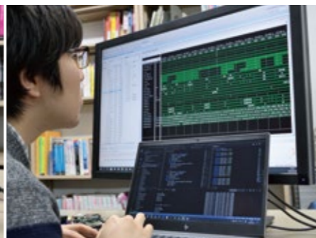
HDLシミュレータが表示する波形図で、設計した論理回路を検証する。
