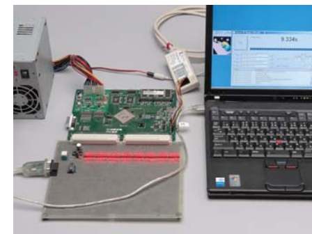
FPGAに回路のデータを送り込んでテストする。
