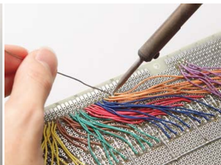
拡張基板上に、追加の素子やLEDをハンダ付け。製作者の好みがあるのでと。
