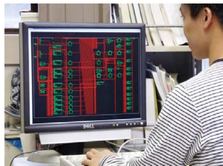
HDLシミュレータで出力信号をチェックし、回路を合成する。
