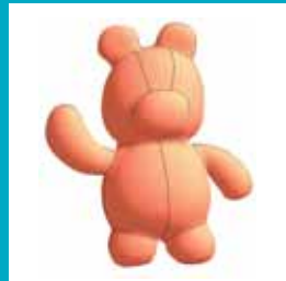
④Pillowで3Dデータから型紙を自動生成。立体モデルに縫い目を書いて、仕上がり形を調整できる。
