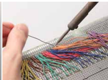
拡張基板上に、追加の素子やLEDをハンダ付け。製作者の好みができる。
